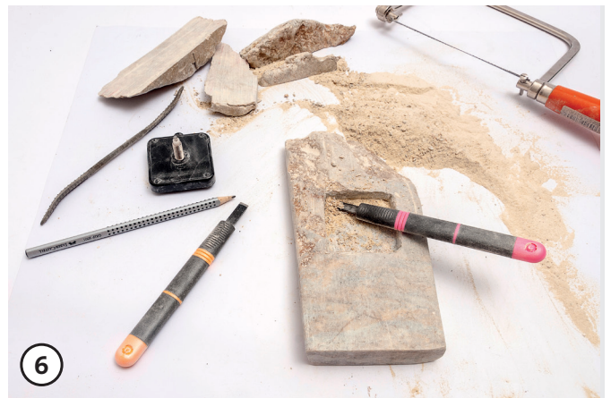
6 Sul retro della pietra steatite, ricavate un incavo per il meccanismo dell'orologio.
