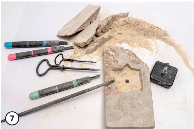
7 Praticare un foro al centro per la filettatura (movimento).
